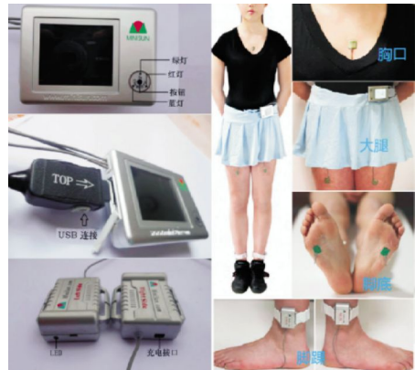
图 1 左侧图为仪器组成,右侧图为参与者佩戴方法,传感器的佩戴位置为:胸骨角下方,双侧大腿前侧中央、双侧踝关节侧方、双侧足底第 4 和 5 跖骨之间。仪器启动后受试者可自由行走,数据自动记录到腰部的主机。
